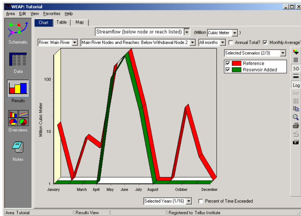
Hình 6-16: Kết quả biến động dòng chảy trên sông, trục logarit
