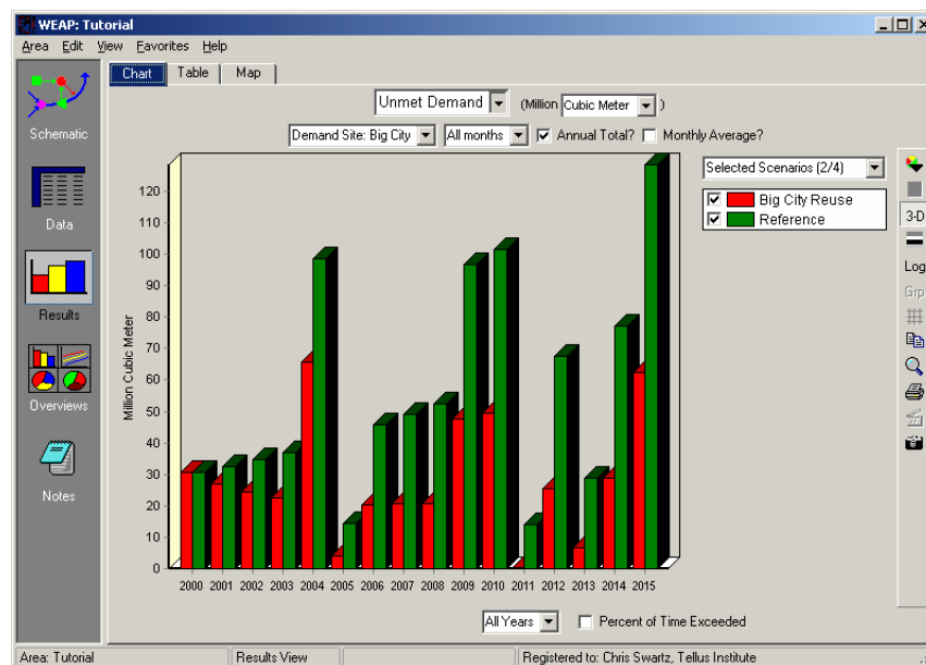
Hình 5-24: Kết quả so sánh 2 kịch bản với lượng tổn thất nước
