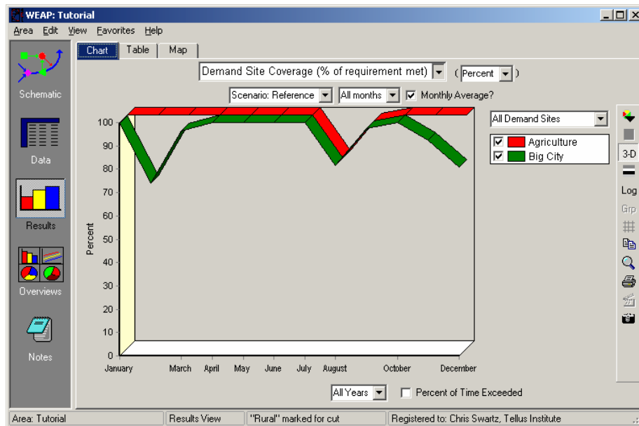
Hình 6-5: Kết quả sau khi bạn thay đổi mức độ ưu tiên cấp nước
